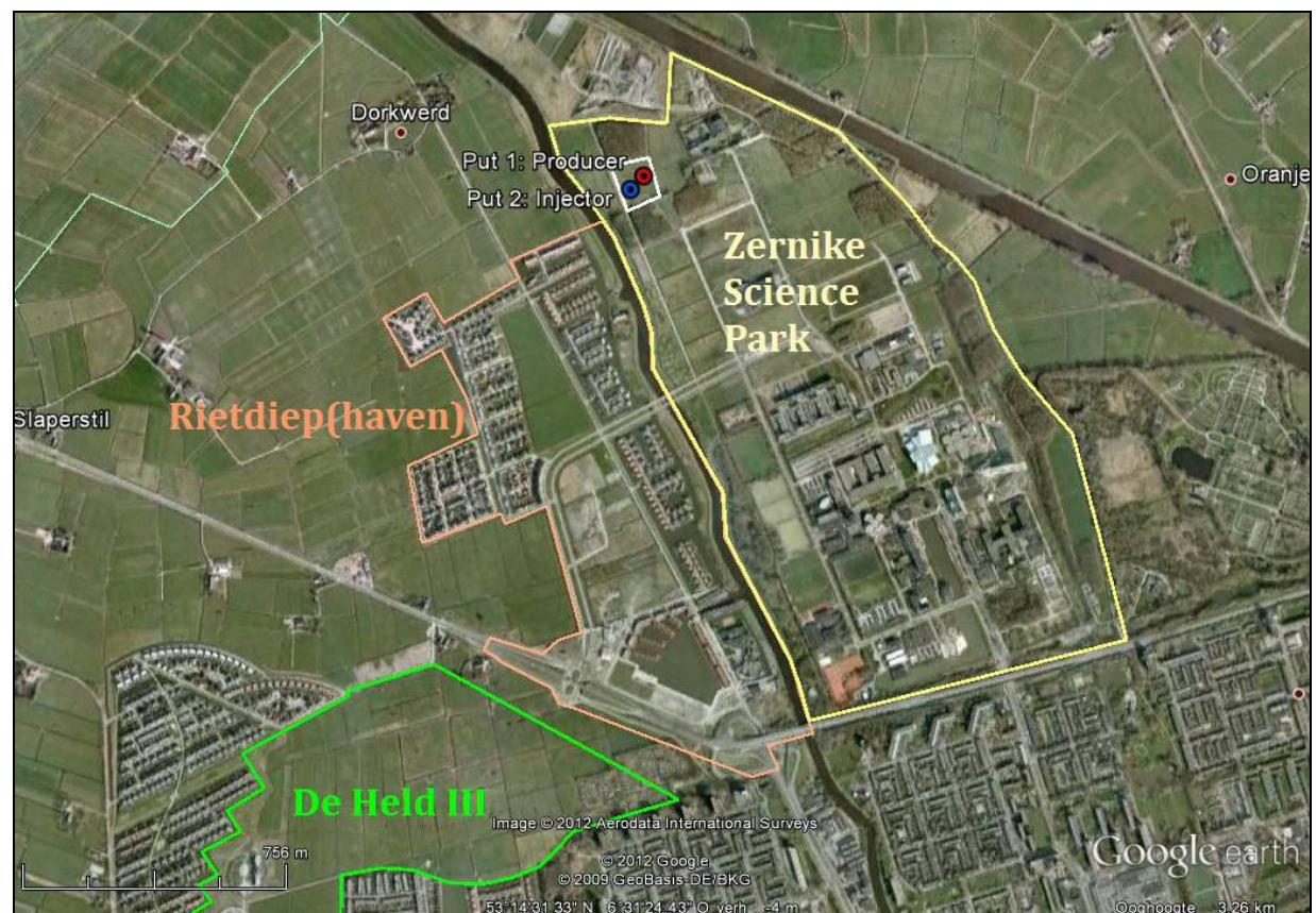
Fig. 10: Zernike Science Park (geel), Groningen. De geplande producer GRO-GT-01 (rood) zal in NW-richting geboord worden. De geplande injector GRO-GT-02 (blauw) zal in ZW-richting geboord worden.
